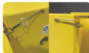
柜门配备自锁装置, 柜门安装闭门器及高温熔断装置, 温度高于100°C, 门自动关闭, 闭门器性能符合GA 93的规定
