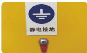
严格按照OSHA规范, 柜身设有静电接地传导接口, 方便连接静电接地导线; 将静电电荷导入大地, 降低静电火花造成的火灾风险
