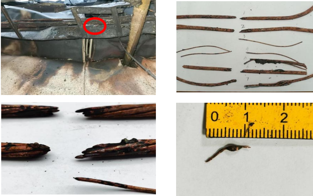
图3 现场起火区域发现的线路熔痕照片
